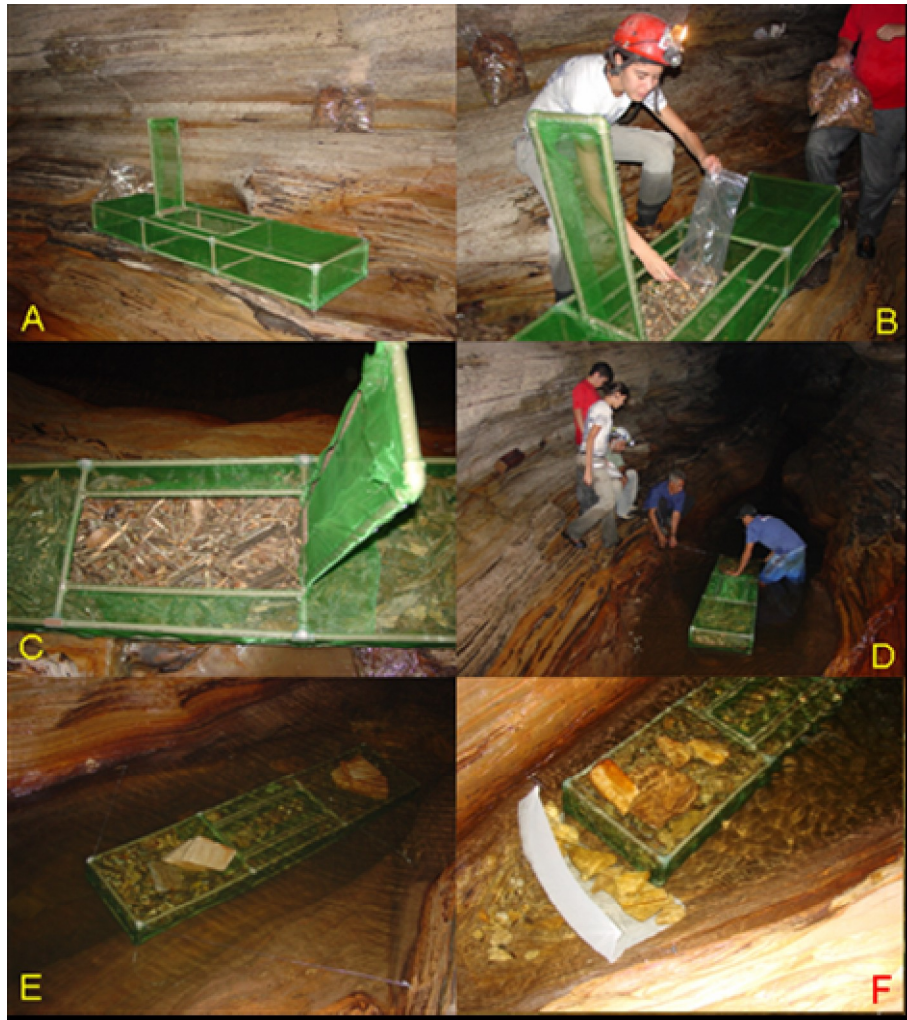
FIGURA 5: (A) Plote de enriquecimento ainda vazio; (B) preenchimento do plot com folhas e gravetos previamente pesados; (C) plote já cheio, com 14kg de matéria orgânica; (D) processo de instalação do plote no piso da caverna; (E) plote fixado por arame na rocha e prensado por pedras e (F) redes instaladas na porção a jusante do plote.
